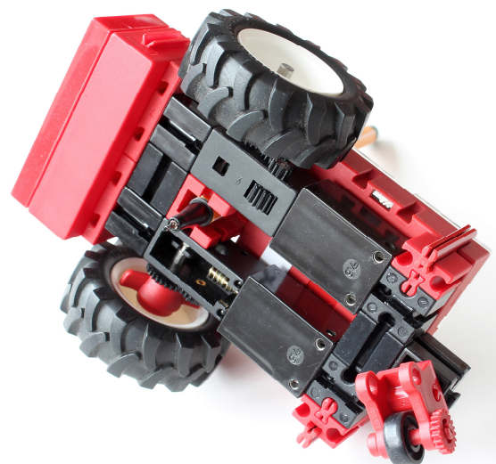
Abb. 2: Ansicht des Malroboters von unten
