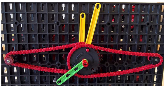
Abb. 10: Freilaufende Räder, von außen von Ketten angetrieben
