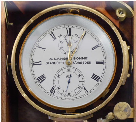
Abb. 3: Kardanisch aufgehängtes Schiffschronometer
