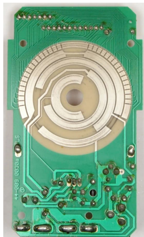
Abb. 9: Fahrregler mit Spannungsteiler und Drehschalter (Leiterbahnseite)
