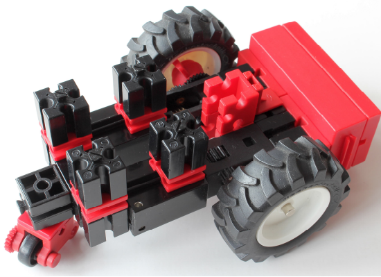
Abb. 7: Fahrgestell des Buggy mit TXT-Anbau
