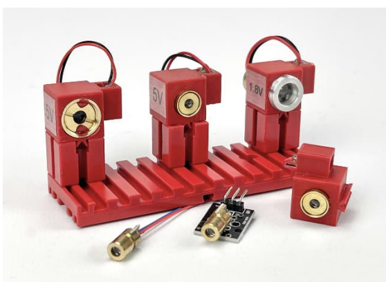
Abb. 4: Laser unterschiedlicher Leistung; separat, als Modul und in 3D-gedruckter Halterung mit JST-PH-Stecker
