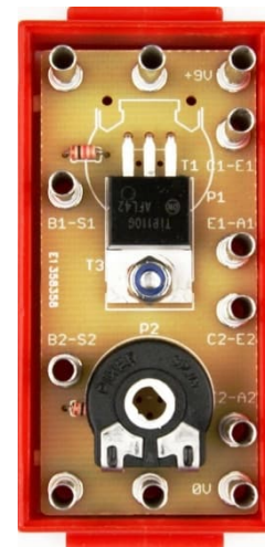
Abb. 316: Nachbau 4: Leistungsstufe im Batteriegehäuse ( 32263 )
