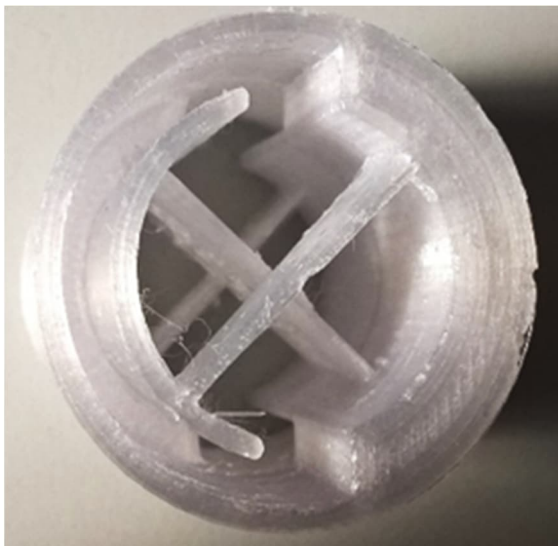
Abb. 11: 3D-Druck eines Flexure-Pivot-Lagers aus PET (30 mm Durchmesser)
