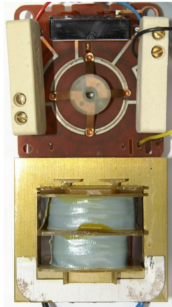
Abb. 4: Trafo 812: Der Polwendeschalter
