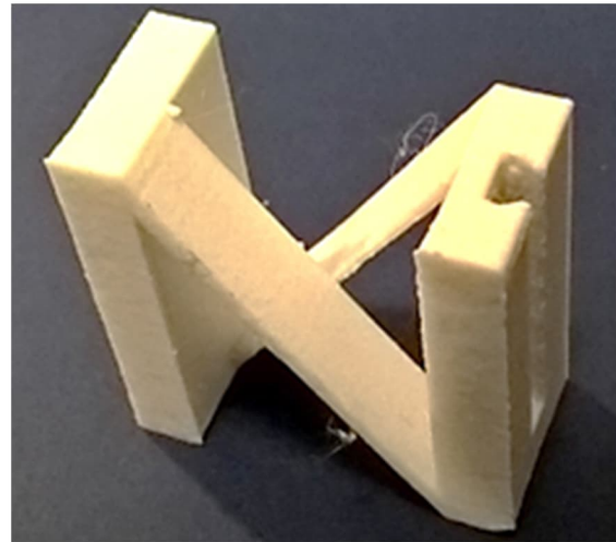
Abb. 12: fischertechnik-kompatibles Kreuzfederlager aus dem 3D-Drucker
