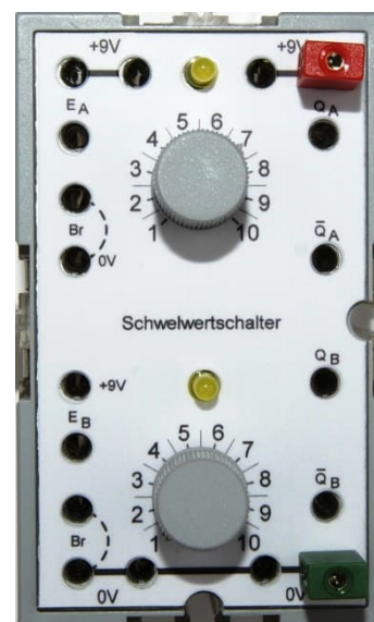
Abb. 321: So hätte der Schwellwert-Schalter in einem Silberling-Gehäuse aussehen können.
