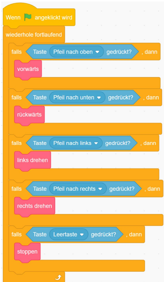
Abb. 10: Fernsteuerung für den Malroboter
