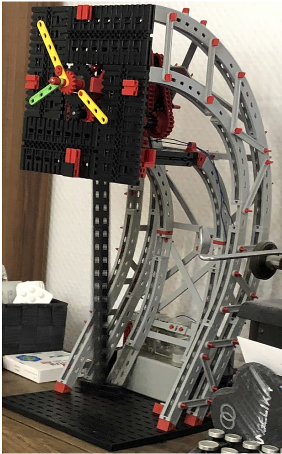
Abb. 13: Die zweite Verwendung des Uhrgetriebes – hier in einer elektromagnetisch angetriebenen Pendeluhr
