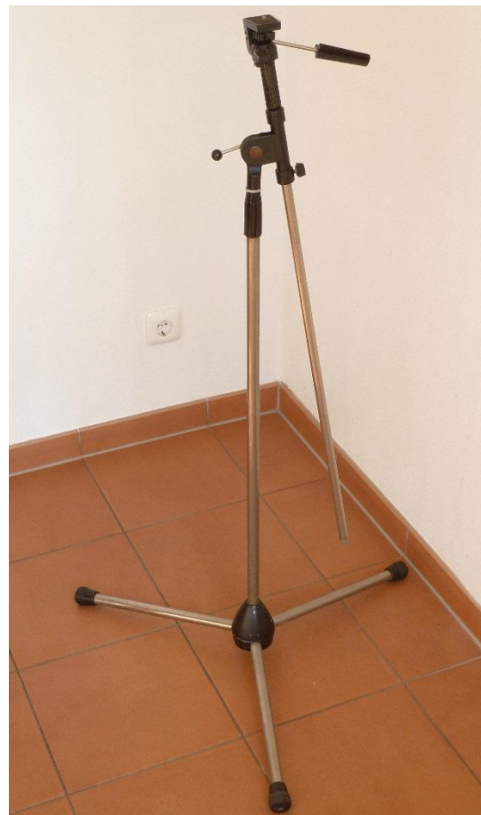
Abb. 1: Ein Mikrofonstativ, auf das der Kopf eines billigen Kamerastativs montiert wurde
