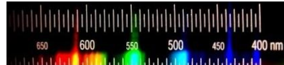
Abb. 4: Spektrum einer billigen Leuchtstoffröhre (Foto: Anton, Quelle: Wikipedia GFDL 1.2)
