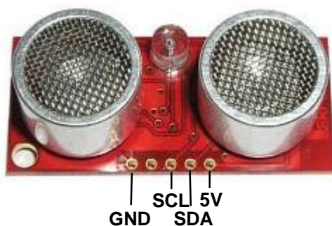
Abb. 3: SRF08 von Devantech, Anschlussbelegung [5]
