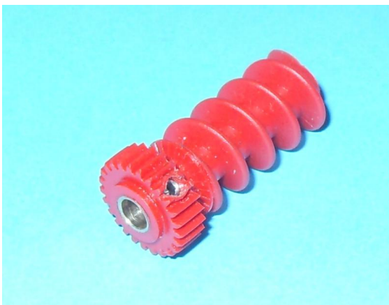
Abb. 4: Modifizierte Schnecke mit Madenschraube zum Anbau an den XM-Motor
