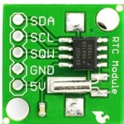
Abb. 3: I 2 C-Board mit RTC-Controller DS1307 (Quelle: watterott.com )
